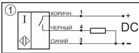
Схема соединения Нормально-разомкнутый контакт
